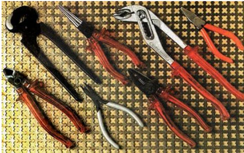
Рис. 1. Слева направо: клещи, круглогубцы, разводной ключ, плоскогубцы (вверху); кусачки, телефонные кусачки, пассатижи (внизу).
